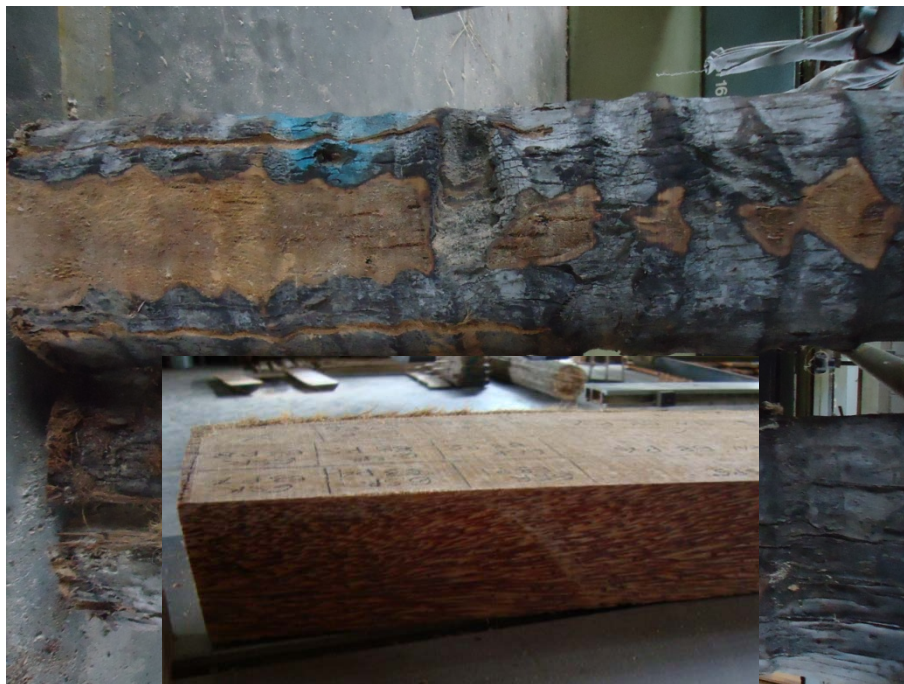
Gambar 3. Hasil pembelahan kayu Glugu (insert: papan kayu hasil pembelahan)
